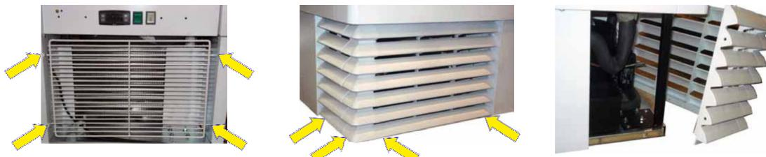
Reinigen Sie die Kondensateinheit mit einer Bürste mit weichen Borsten und einem Staubsauger; führen Sie die folgenden Schritte durch bei dieser Operation darauf achten, nicht die Lamellen des Kondensators zu verbiegen.
